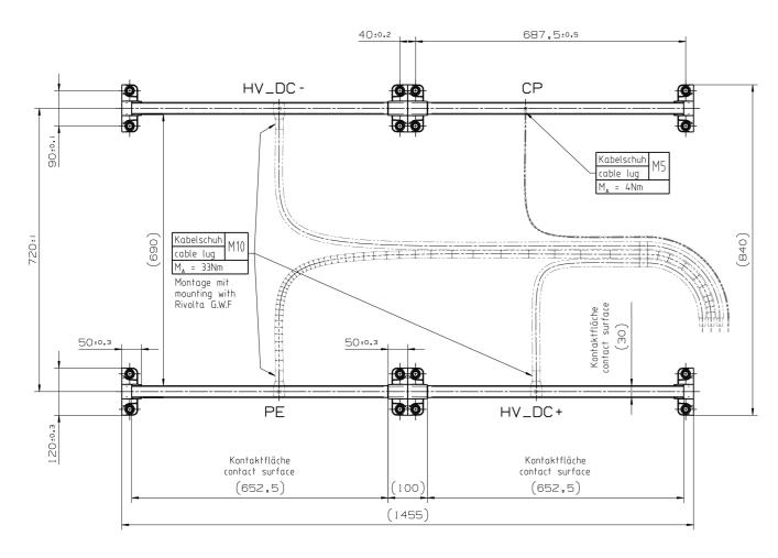
Anordnung auf Fahrzeug / arrangement on vehicle Fahrtrichtung / driving direction
